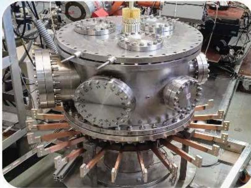
नवनिर्मित SMARTEX-C वैक्यूम चैम्बर Upgraded SMARTEX-C vacuum chamber
